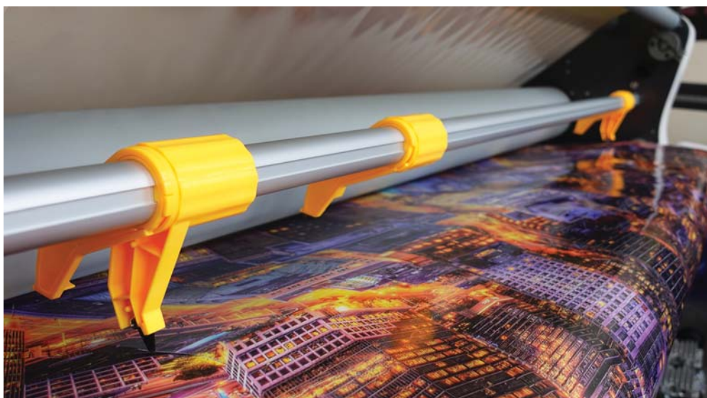
Каждый ламинатор оснащен ножами для подрезки пленки
